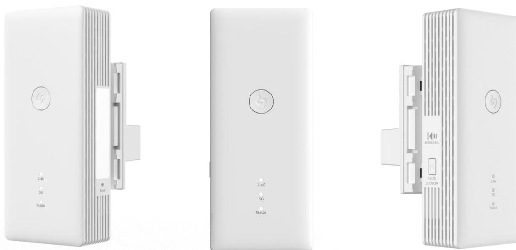
従来の埋め込み式 Wi-Fi は、壁内部に設置されるため放熱性に課題があり、特に夏場の高温環境では故障のリスクが高まる傾向がありました。これに対し、「脱着式 Wi-Fi」はユニットを壁の外に配置することで放熱性を向上させ、より安定した通信環境を提供します。
